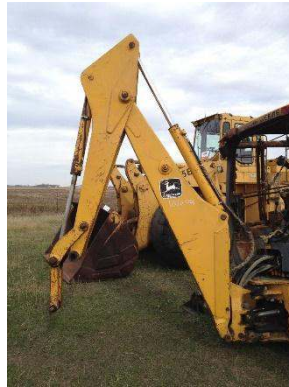
Gambar 4.5 Bucket backhoe yang terlepas
