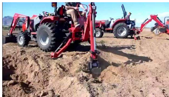
Gambar 4.4 Gerakan boom pada backhoe
