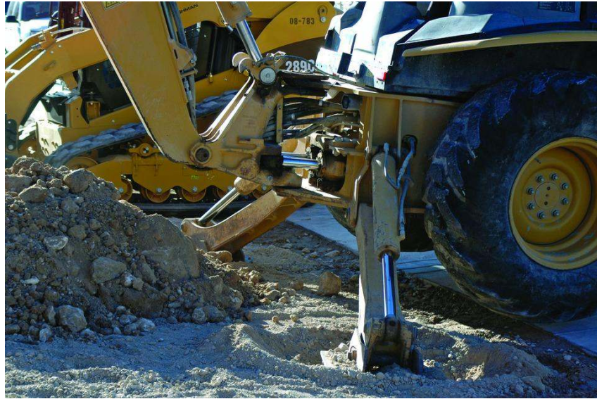
Gambar 6.12 Kegunaan Stabilizer Ketika Mengendarai Backhoe
