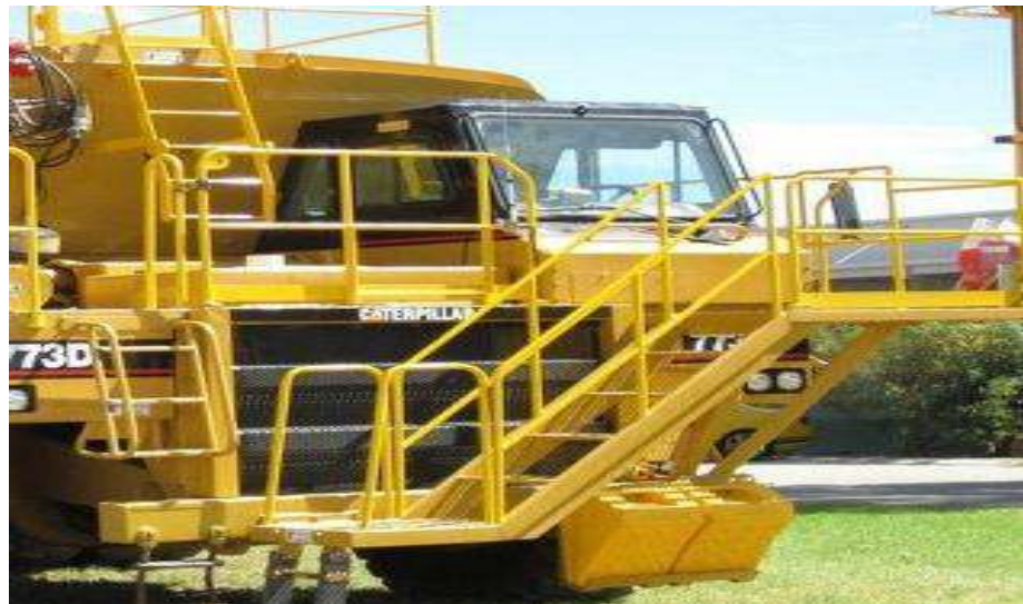
Gambar 4.21. Tangga pada Water Tank Truck
