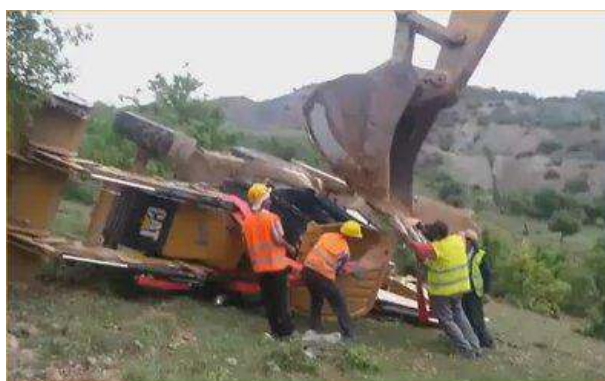
Gambar 6.15 Resiko Terguling Ketika Mengendarai Backhoe
