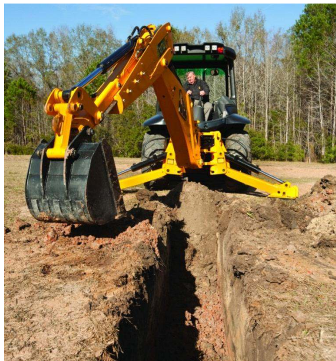
Gambar 6.13 Tips Posisi Stabilizer dan Tanah dari Backhoe
