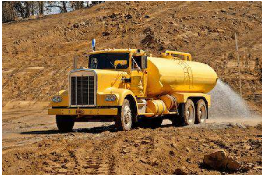
Gambar 6.31 Penyemprotan dengan Water Tank Truck di Area Tambang
