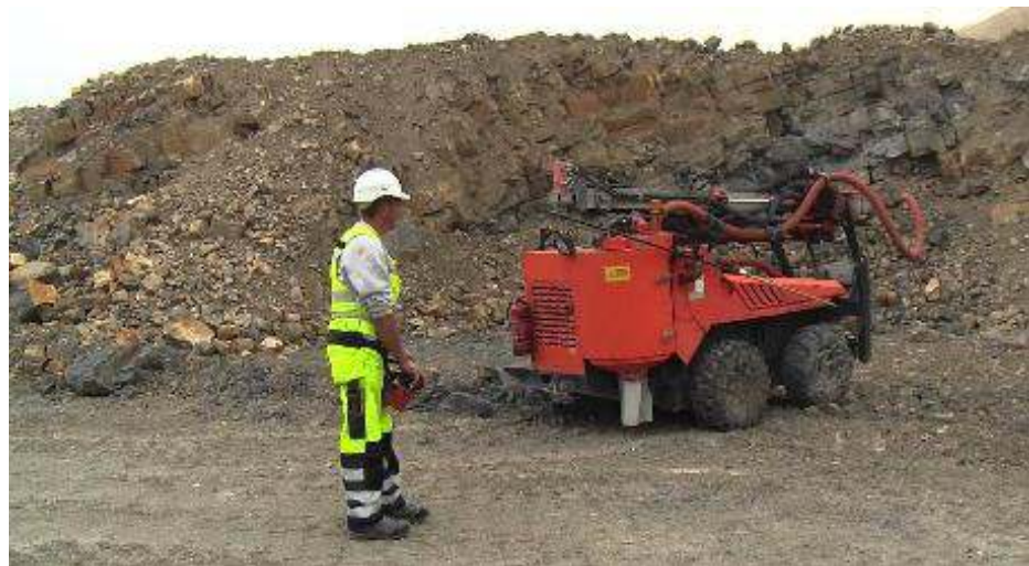
Gambar 4.51 Pengoperasian Tamrock dengan Remote Control
