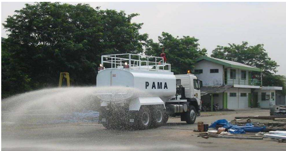
Gambar 6.30 Penyemprotan dengan Water Tank Truck di Area Datar
